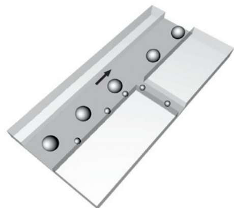
圖4 子液滴與母液滴於第二個 T 型結構處之分離現象。
