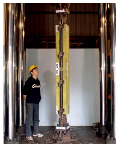
圖4 可拆解式挫屈拘束支撐試驗。
