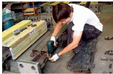
圖3 可拆解式挫屈拘束支撐組裝過程。
