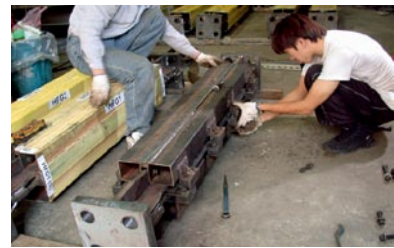
圖2 可拆解式挫屈拘束支撐斷面示意圖。
