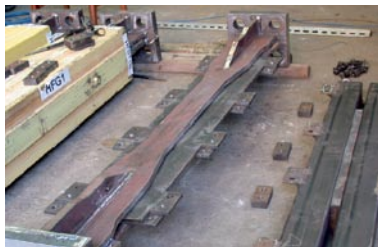
圖1 可拆解式挫屈拘束支撐的構造。
