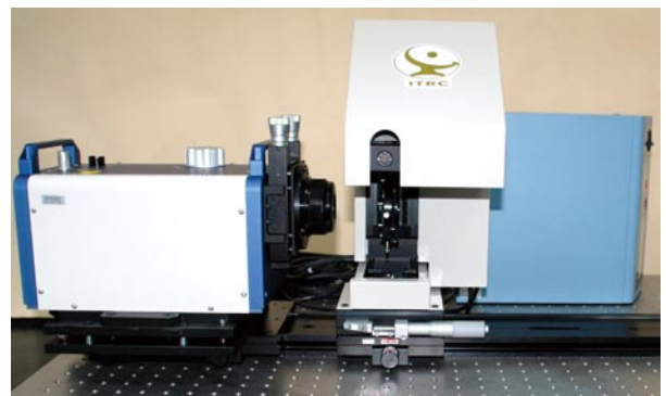
圖14 透鏡偏心與傾斜之干涉儀量測方法與裝置。
