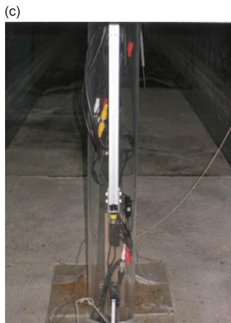
圖8 探針式橋墩沖刷即時監測系統 (a) 系統示意圖；(b) 實體構造圖；(c) 試驗佈置情況。
