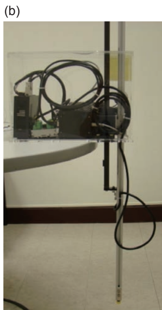
圖8 探針式橋墩沖刷即時監測系統 (a) 系統示意圖；(b) 實體構造圖；(c) 試驗佈置情況。
