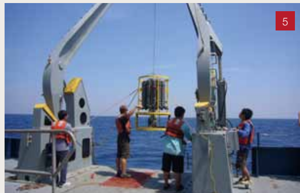
5 海洋水文、水體溫鹽深儀垂直取樣作業
