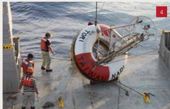
4 海氣象資料即時傳輸錨碇回收作業
