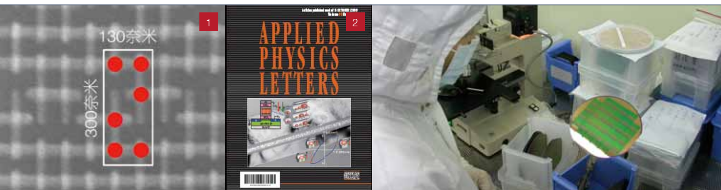
1 國研院奈米元件實驗室所開發的16奈米世代元件(靜態隨機存取記憶體, SRAM)。在白色框線之內就有6個電晶體,相當於1平方公分內有150億個電晶體。此元件容量約是目前45奈米元件的10倍,且耗電量預期可減少一半。 2 獲選為著名應用物理期刊“Applied Physics Letters”封面論文。
