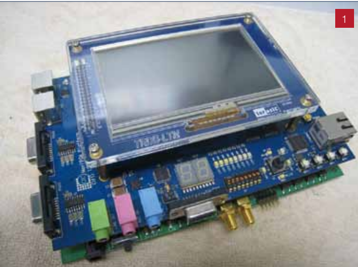
1 多媒體影音觸控式LCD模組與FPGA核心模組
