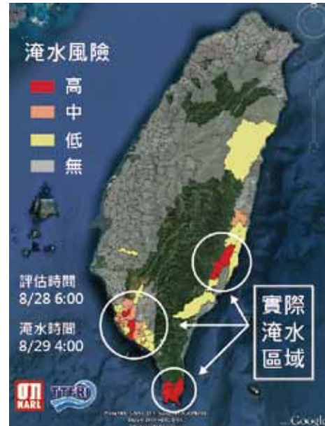
圖3 南瑪都颱風（2011）侵台期間，都會區淹水快速評估系統所估計之淹水風險與實際淹水區域。
