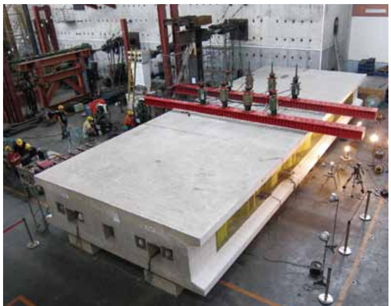
圖1 進行三箱室縮尺波形鋼腹板複合橋斷面力學實驗，該橋梁工法已應用於台中四號生活圈
