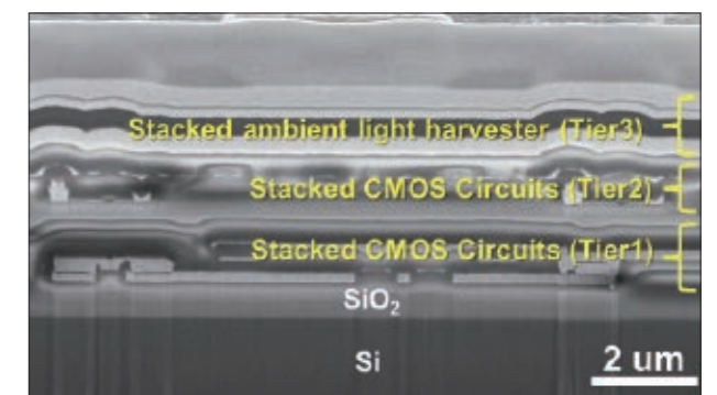
▲ 具環境光能採集技術之積層型三維積體線路晶片之電子顯微鏡圖
