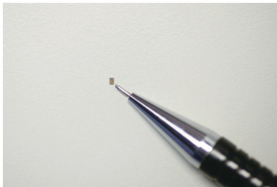
▼1mmx1mm 大小的能量擷取管理晶片圖
