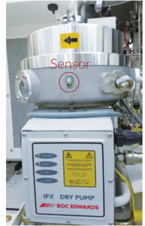
▼ 奈米積體式振動感測器架於八吋蝕刻機之真空幫浦上，可即時檢測幫浦振動情形
