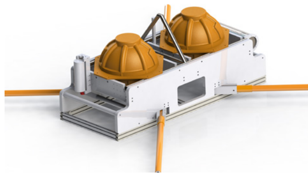
▲ 海洋中心與中研院合作研發之海底電磁儀 TORI and Academia Sinica develop the electro-magnetometer
