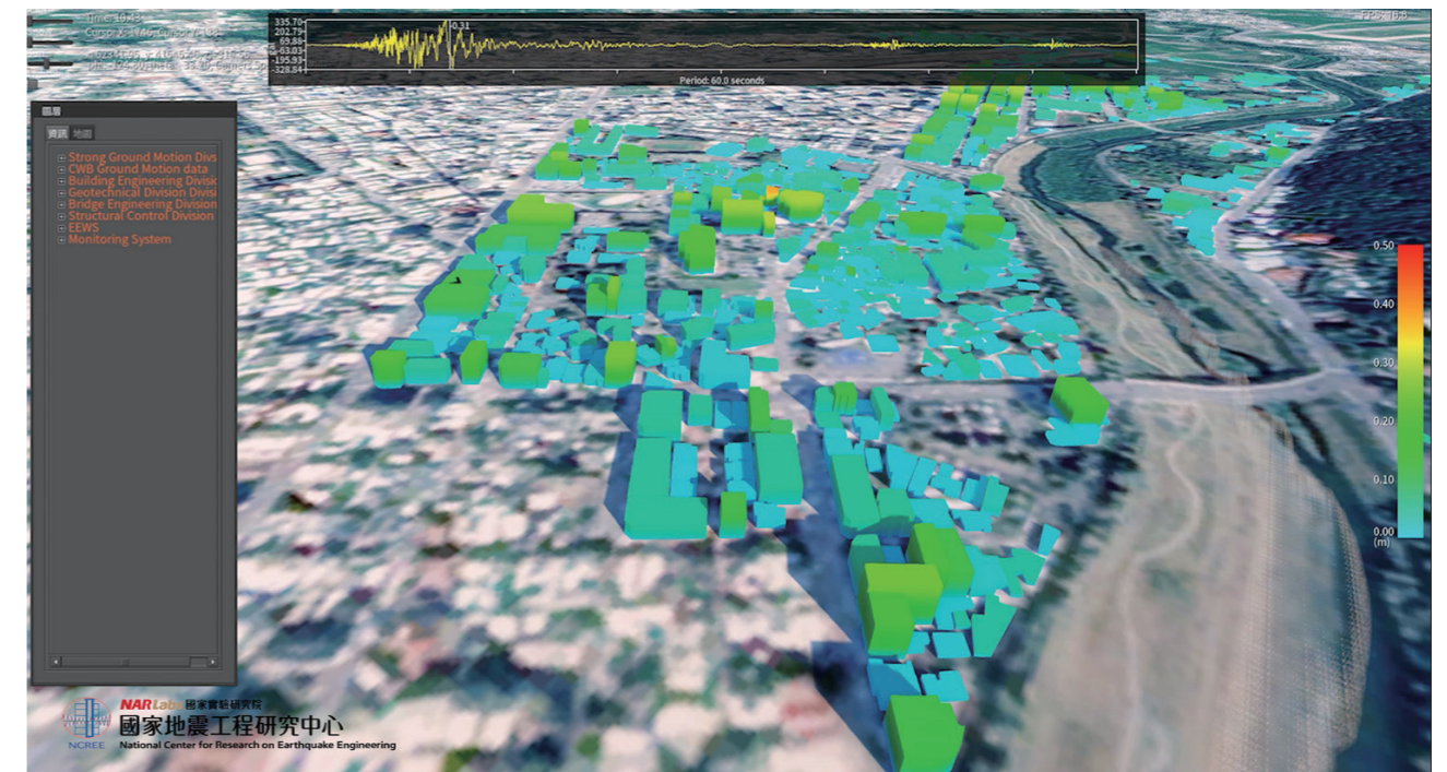
▲「5D 智慧城市防救災平台」模擬受損程度
